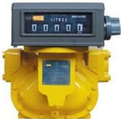
Объёмные расходомеры серии М представляют из себя измерительную камеру, в которой вращаются три ротора (цилиндрический ролик особой конструкции и две лопатки) без контакта друг с другом и корпусом. Каждый ротор опирается осью на несущую плиту. Лопатки вытеснительных роторов поочередно вращаются таким образом, что создаётся постоянное капиллярное уплотнение между деталями прибора. Это же уплотнение надёжно разделяет измеренный и еще не измеренный контролируемый жидкий продукт.
